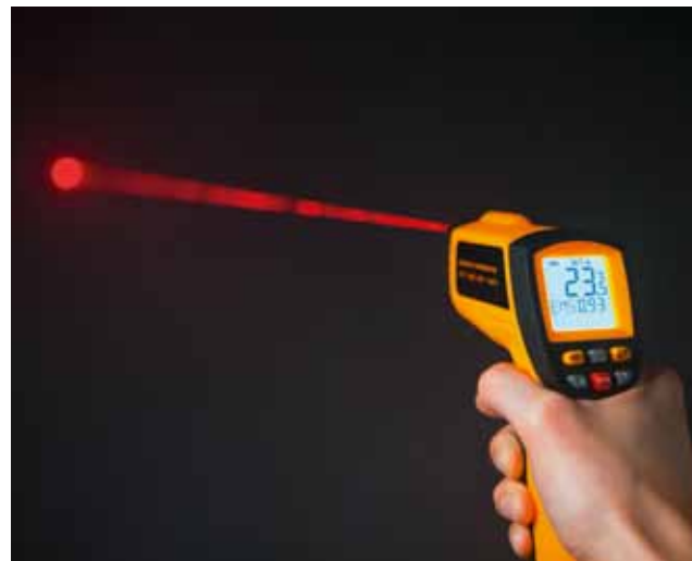
Bei der Messung von Oberflächentemperaturen mit einem Infrarotthermometer (Pyrometer) handelt es sich um eine berührungslose Messmethode.
