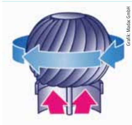
Funktionsprinzip eines Airmaster-Ventilator-Systems
